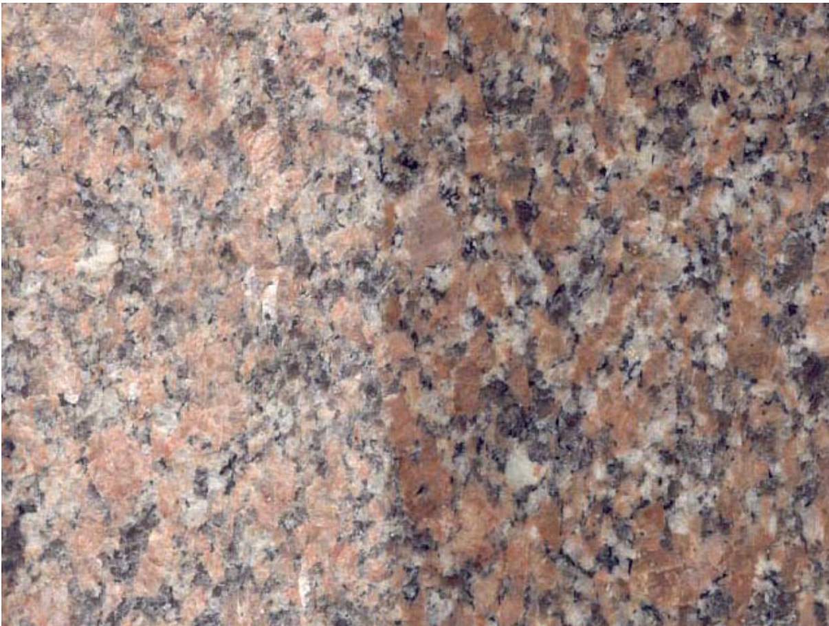
Rys. 26: wygładzone i niewygładzone powierzchnie granitu różowego.
