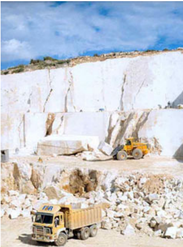
Rys. 7: typowa kopalnia odkrywkowa trawertynu.
