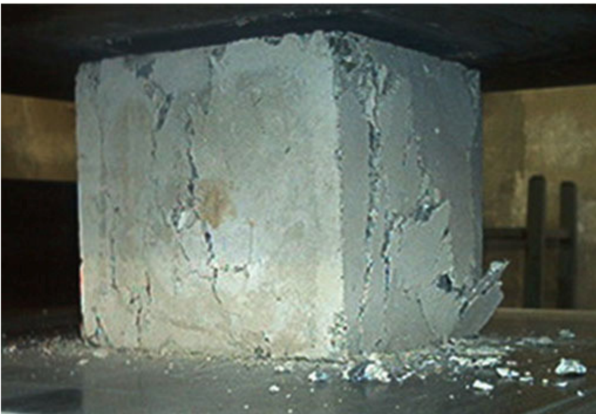
Rys. 3: kamień pod prasą hydrauliczną dla sprawdzenia jego wytrzymałości na ściskanie.
